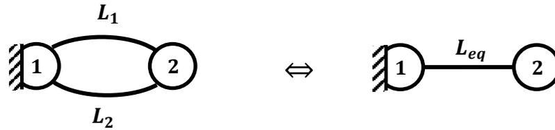
Des liaisons en parallèle permettent généralement de répartir les efforts que chacune va subir dans un contexte de dimensionnement de mécanismes. L'ensemble des plusieurs liaisons entre deux pièces réalise une nouvelle liaison à mobilité inférieure ou égale à la mobilité de chacune des liaisons.
