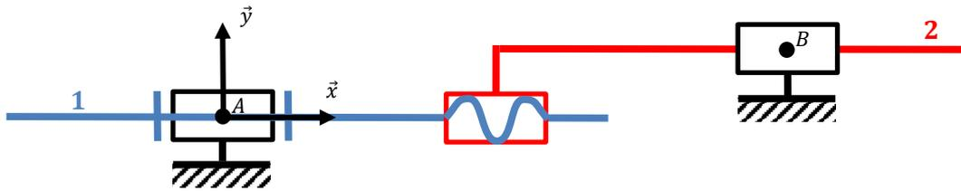
Définissons  $\vec{F}_{21} = F_{21}\vec{x}$  et  $\vec{C}_{21} = C_{21}\vec{x}$  les efforts/couples de la pièce 2 sur la pièce 1 dans la liaison hélicoïdale.
