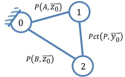
Appelons  $\vec{C}_1 = C_1 \vec{z}_0$  le couple d'entrée, de l'extérieur sur la pièce 1 selon l'axe  $(A, \vec{z}_0)$  et  $\vec{C}_2 = C_2 \vec{z}_0$  le couple de sortie, transmis par la pièce 2 à la sortie selon l'axe  $(B, \vec{z}_0)$
