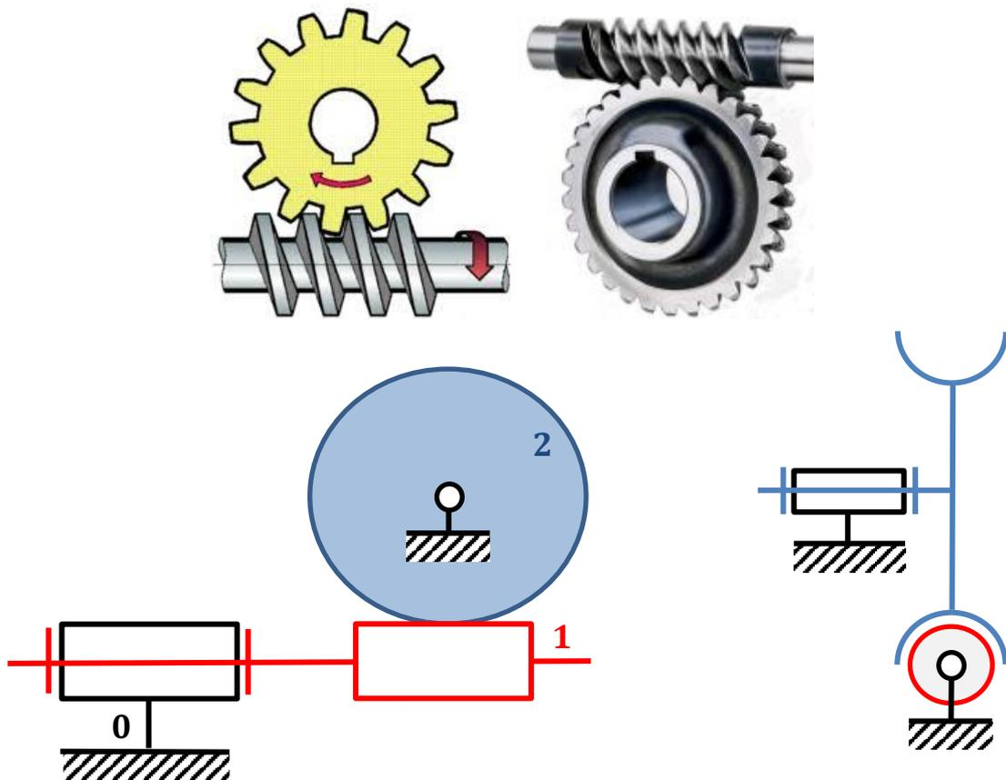
Déterminons le rapport statique au signe près (dépend des conventions choisies sur les axes des pièces, la définition des couples, et le positionnement de la roue 2).
