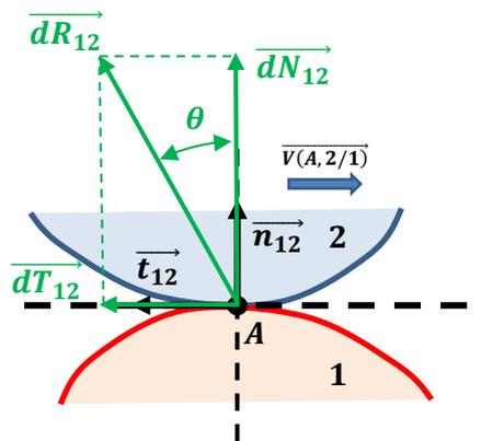
L'action tangentielle de 1 sur 2 de frottement **s'oppose au mouvement possible de 2 par rapport à 1 si le contact était parfait**, que le mouvement ait lieu ou non.
