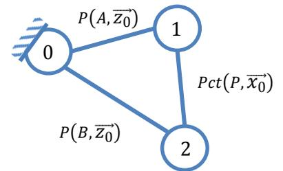
On suppose qu'il y a roulement sans glissement entre 1 et 2 en P.
