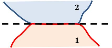
On peut utiliser la théorie de Hertz pour caractériser déformations et contraintes au niveau local. Dans nos modèles, on pourra considérer que lorsqu'il y a contact et mouvement de rotation, il y a une résistance au roulement. En effet, du fait du mouvement, la pression ne se répartit pas uniformément sur la surface de contact. On peut la représenter comme suit :
