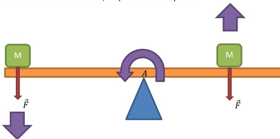
L'origine du basculement est une différence de moment des deux forces  $F$ . L'action en  $A$  s'oppose toujours au poids des deux forces et ne change pas de valeur ( $\vec{F}_A = 2Mg\vec{z}$ ), mais il existe une « force en rotation », appelée moment, qui tend à faire basculer l'ensemble vers la gauche.
