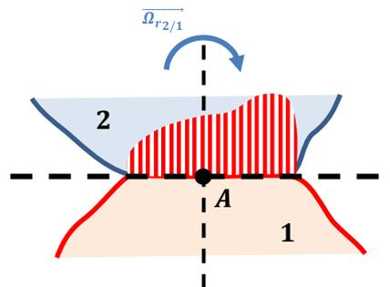
La résultante de l'action de pression peut alors se représenter comme un effort normal qui ne passe pas par le centre de la surface de contact, mais qui est décentré d'une distance  $\mu$  en amont dans le sens du mouvement et qui génère un couple de résistance au roulement :
